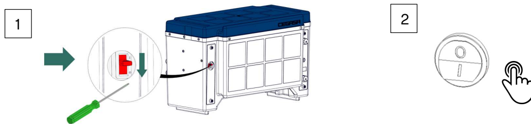
Abbildung 6-3 Deaktivieren Sie die Leistungsschalter (CB) und belassen Sie den Schalter in der Position „O“ (AUS-Stellung).
