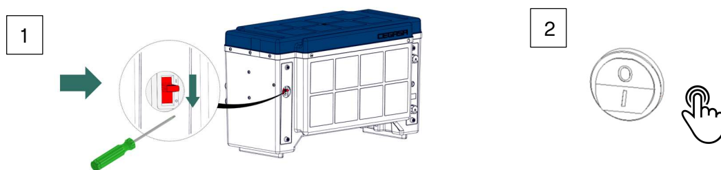
Figura 6-3. Desconectar los disyuntores (CB) y dejar en posición "O" (OFF) el Interruptor.
